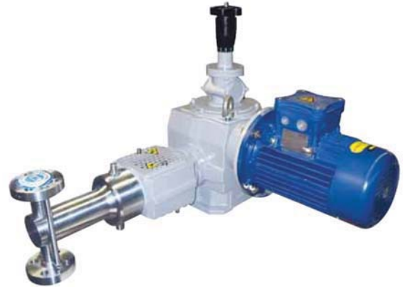
Насос серии LNTLF. Благодаря рубашке охлаждения и специальным уплотнениям плунжера данный насос может перекачивать среды с максимальной температурой 280 °С
