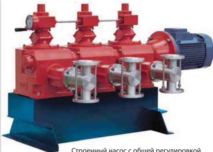
Строенный насос с общей регулировкой длины ходов трех плунжеров при помощи маховика с гравитационным циферблатом
