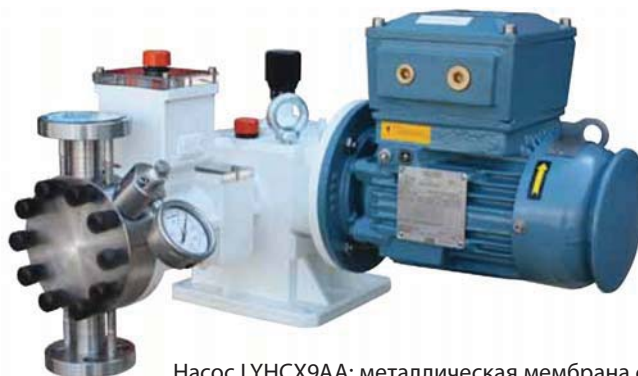
Насос LYHCX9AA: металлическая мембрана с системой обнаружения пробоя при помощи манометра и датчика пробоя (датчик пробоя установлен заказчиком самостоятельно).
